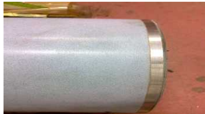
Keramički sloj 0,5 mm nakon brušenja
