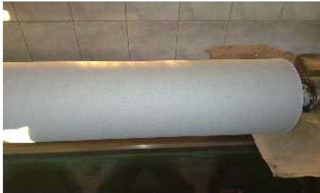
Naneseni sloj keramike prije brušenja
