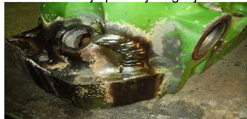
Zavareno kućište—Castolin DO 23
