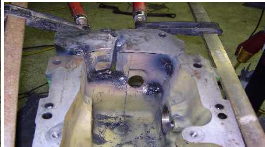
Fiksiranje polomljenog dijela
